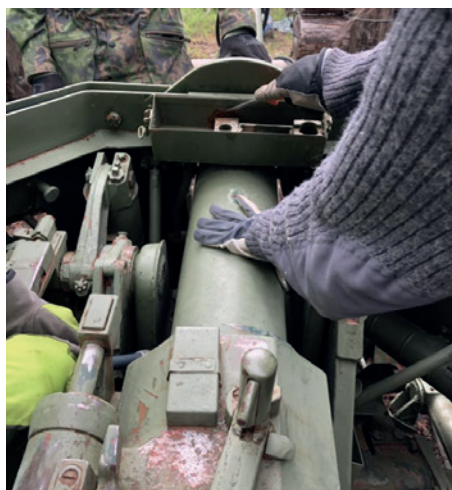
Kanuunan huollossa myös puukko kävi työkalusta ahtaasta tilasta liikaa ja pientä pintaruostetta poistettaessa.
